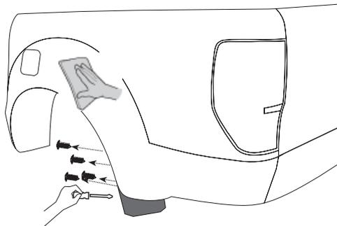
2. Entfernen Sie die verbliebenen Schrauben an den gezeigten Positionen
