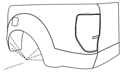
4. Entfernen Sie jeweils an den Klebebandenden die Schutzfolie 5 bis 7 cm
