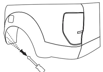
3. Drücken Sie nun die Kotflügelverkleidung vom Kotflügel und schieben Sie die Klemmen von innen über den Kotflügelrand, so dass die Bohrungen bündig sind. Achten Sie darauf, dass die Klemmen den Korrosionsschutz nicht beschädigen.
