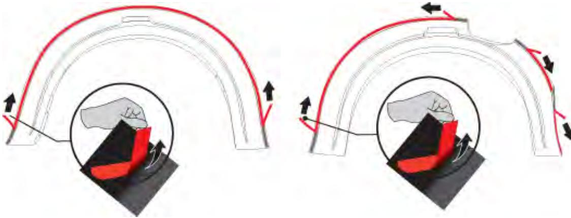
5. Positionieren Sie die Kotflügel korrekt und drücken Sie die Teile leicht an. Befestigen Sie nun den Kotflügel indem Sie die beiliegenden Schrauben und Unterlegscheiben in den Löchern wieder einsetzen und fest anschrauben. Gegebenenfalls Schmutzfänger auf dem Kotflügel aufsetzen und mit anschrauben.
