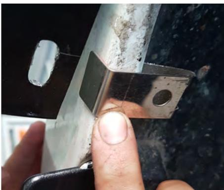
**X** Für die rot markierte Bohrung muß der beiliegende Metallbügel von innen auf den Kotflügelrand geschoben werden. Nun kann die Schraube durch die Bohrungen in der Verbreiterung eingeschraubt werden.
