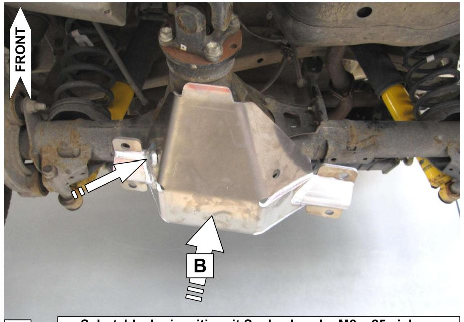
Schutzblech einseitig mit Senkschraube M8 x 25 sichern Secure the skid plate one sites with countersunk screw M8x25!
