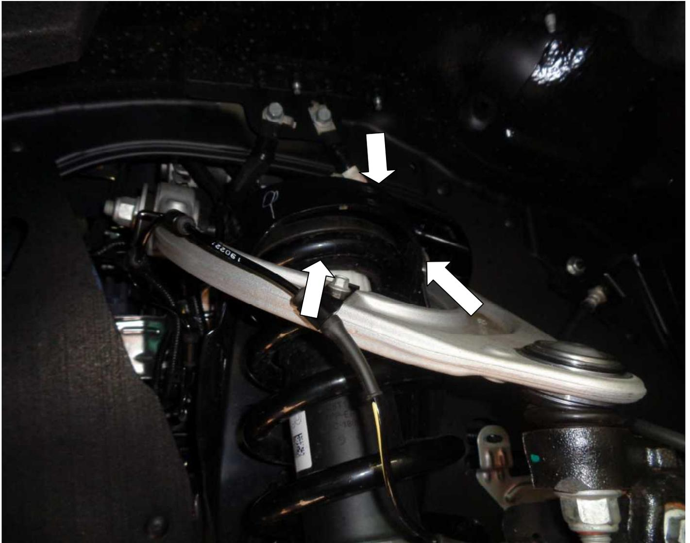
2. Schrauben des Federbeines lösen
