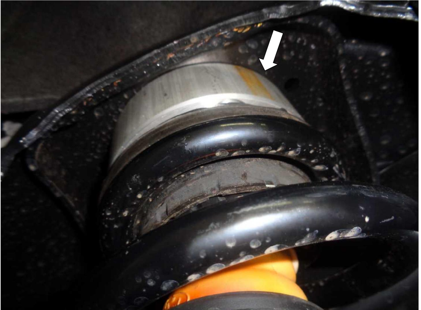
4. Feder Ausbauen und mit Distanzring neu befestigen.
