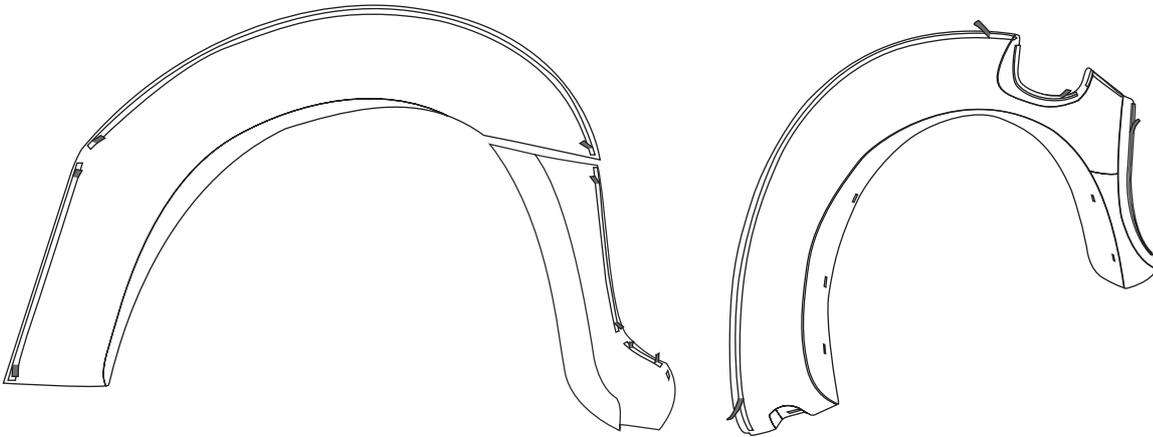
7. Positionieren Sie die Kotflügel korrekt und drücken Sie die Teile leicht an. Überprüfen Sie die korrekte Position und ziehen Sie dann das restliche Schutzfolie ab.
