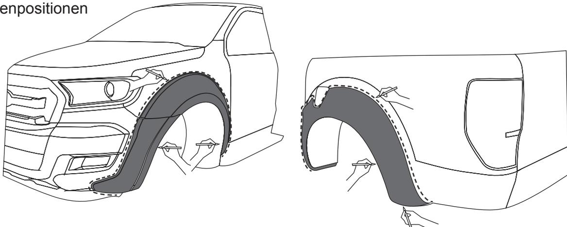
4. Bohren Sie die Löcher mit einem 3 mm Bohrer und versiegeln Sie den metallisch blanken Teil der Bohrlöcher mit Korrosionsschutzmittel
