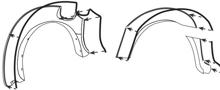
3. Positionieren Sie die Kotflügel korrekt und markieren Sie die Aussenränder sowie die Schraubenpositionen
