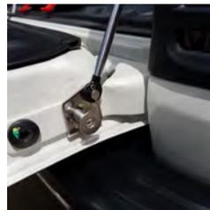
5. Äsetzen Sie den Dämpfer an der Heckklappe an und schrauben Sie diesen mit der beiliegenden Schraube fest.
