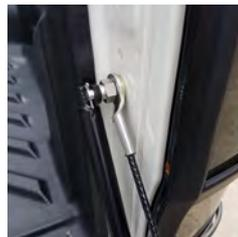
3. Äsetzen Sie den Dämpfer am Fangseilhalter an und sichern Sie diesen mit dem beiliegenden Federstift.
