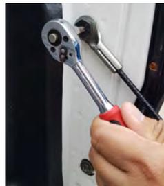
1. Fangseilschraube lösen.
