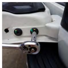
4. ÄHeckklappenschraube lösen.
