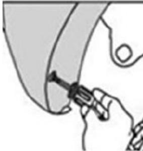
3. Lösen Sie die Schutzfolie vom doppelseitigen Klebeband auf den Radläufen
