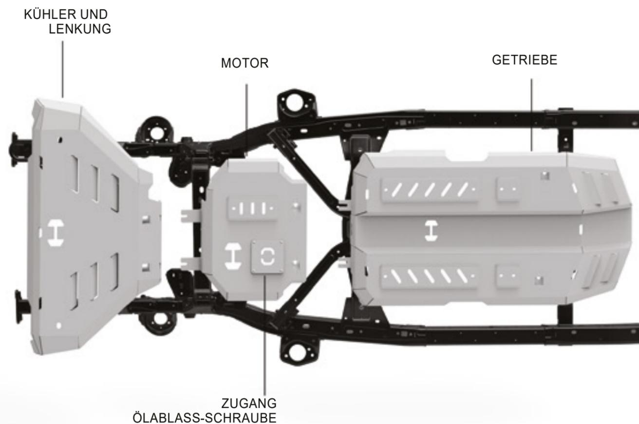
DIE NEUEN HAMER ALUMINIUM UNTERFAHRSCHUTZ PLATTEN AUS 6MM HOCHFESTEM ALUMINIUM. ENTWICKELT UND KONSTRUIERT, UM EINE SCHÜTZENDE BARREIRE FÜR DIE WICHTIGSTEN KOMPONENTEN UNTER DEM FAHRZEUG ZU BIETEN. DIE HAMER UNTERFAHRSCHUTZ PLATTEN BIETEN OPTIMALEN SCHUTZ UND EINE HOHE LEBENSDAUER.
