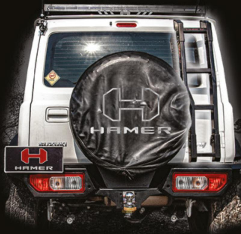
DIE HAMER HECKLEITER FÜR SUZUKI JIMNY IST EINE VIELSEITIGE HECKLEITER AUS HOCHWERTIGEN MATERIALIEN, STARK UND LANGLEBIG, EINFACH UND SCHNELL ZU INSTALLIEREN. KANN EIN MAXIMALES GEWICHT VON 150 KG TRAGEN, MODERNES UND SCHÖNES DESIGN, GEEIGNET ZUM EINFACHEN UND BEQUEMEN BE- UND ENTLADEN DES DACHTRÄGERS.
