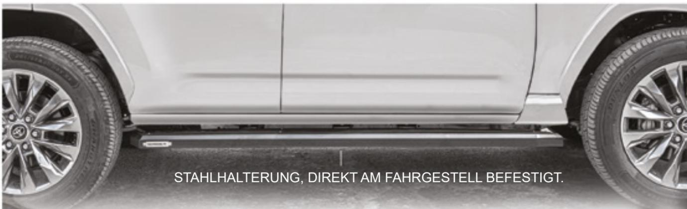
STAHLHALTERUNG, DIREKT AM FAHRGESTELL BEFESTIGT.
